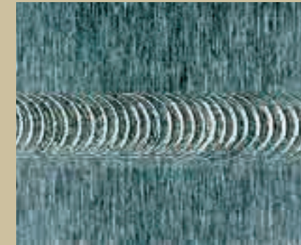
シーム溶接: sus304 Seam Welding
